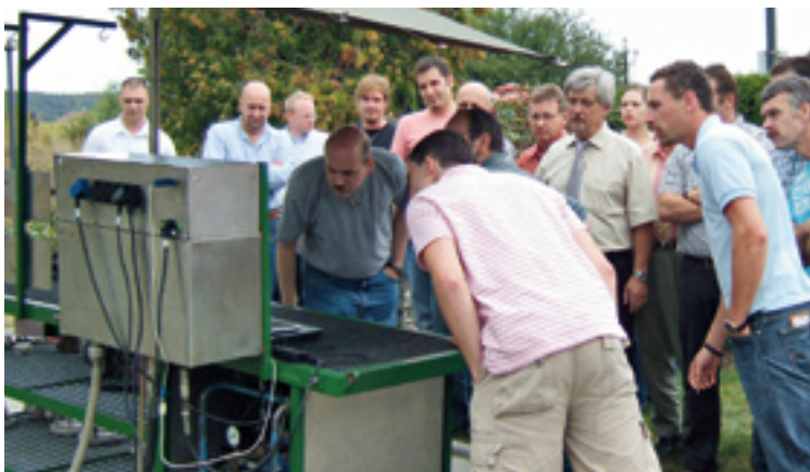
Der Verlauf der Druckkurve der zu prüfenden Schlauchleitung wird von den Teilnehmern genauestens beobachtet
